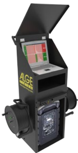
Система фальстарта встроенная в тележку, включая контроллер, громкоговоритель и аккумуляторы
